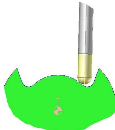
Schaftdurchmesser des Werkzeugs: Ermöglicht das Definieren des Durchmessers des Werkzeugschafts.
