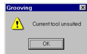
Diese Meldung erscheint, wenn ein Werkzeugwechsel ansteht und sich das zuletzt benutzte Werkzeug nicht an der Position für den Wechsel befindet. Beim Drehen kommt es vor, dass der Anwender das Werkzeug dort auswechseln will, wo es gerade steht, d.h. ohne Rückfahrt zur Werkzeugwechselposition (z.B. um Zeit zu gewinnen). In diesem Workshop reagieren wir immer mit **JA**.
