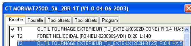
Die Positionierung der Werkzeuge in den verschiedenen Werkzeughalterungen durch Klicken auf **VERLASSEN** bestätigen validieren.
