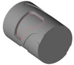
Markieren Sie die Kurve, die die Inseln bildet (ebene oder aufgewickelte Kurve). Diese muss unbedingt GESCHLOSSEN sein.
